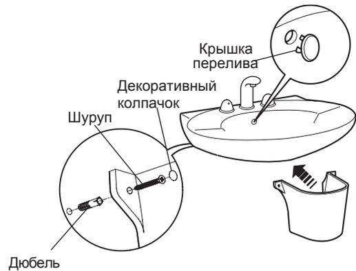
1. Определите положение полупьедестала и отметьте положение крепежных отверстий.
